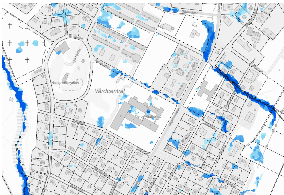
Figur 26: Skyfallskartering över planområdet som visar översvämningsdjup vid ett 100-års regn. Ljusblå färg indikerar ett djup på 0,1 – 0,3 meter och mörkblå ett djup på 0,3 – 0,5 meter
