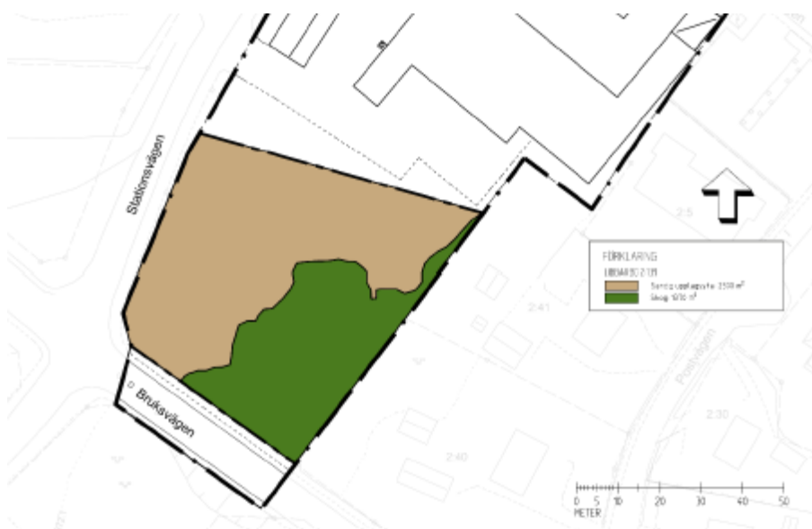
Figur 17: Planritning som visar utbredningen av två olika befintliga yttyper av skiljande karaktär och avrinningskoefficient inom fastighet Libbarbo 2:139
