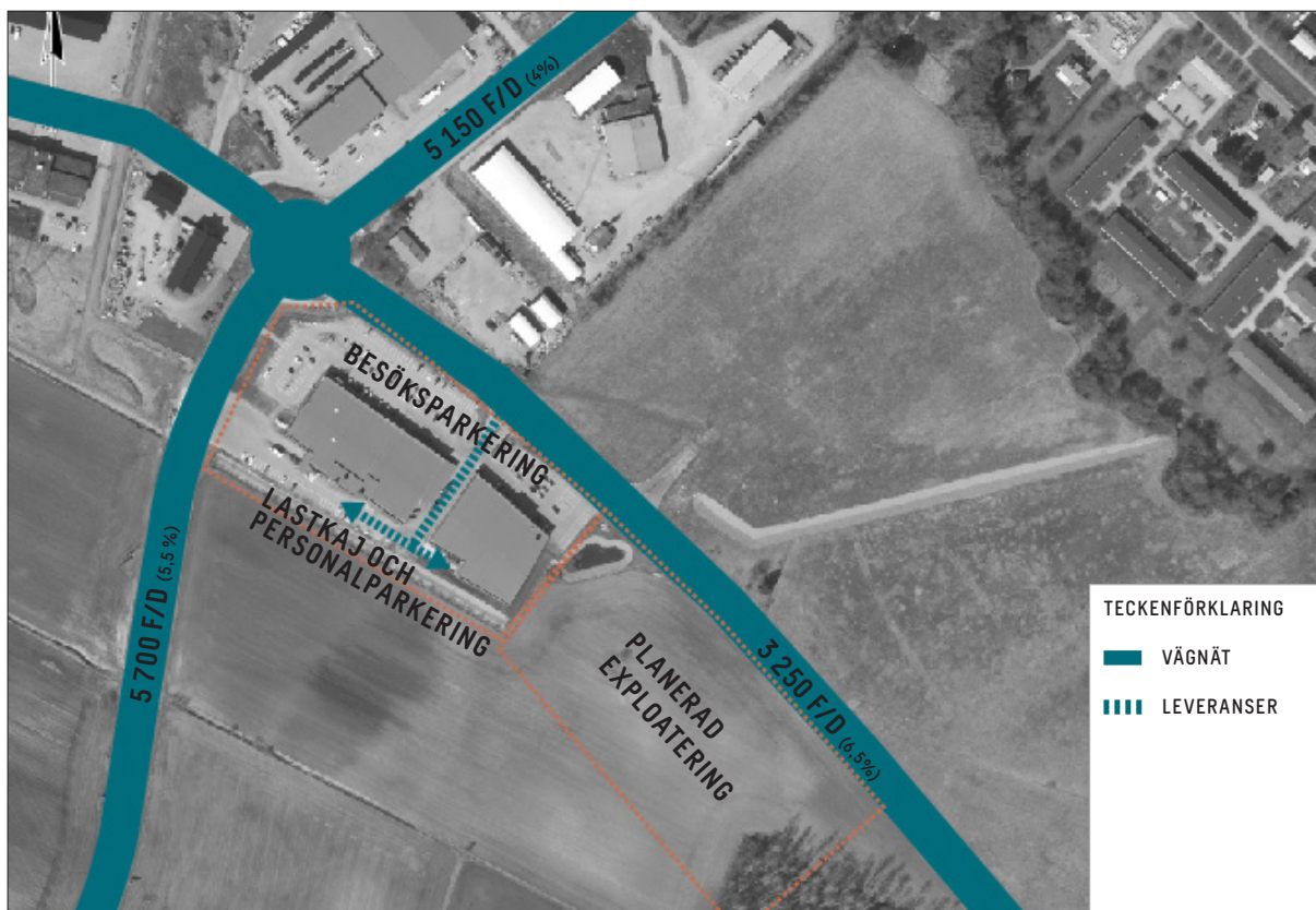
FIGUR 4. VÄGNÄT OCH TRAFIKFLÖDEN I ANSLUTNING TILL UTREDNINGSMÅLET, REDOVISADE TRAFIKFLÖDEN ÄR FRÅN 2021 OCH UTGÖR ÅRSMEDELSDYGNSTRAFIK (ÅDT).
